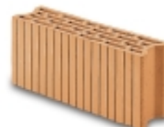
About 15 T10 x 15 x 37,5 cm - 5 kg 180 pièces/palette - 2,7 pièces/ml Autre format T10 x 15 x 33 cm - 4,3 kg 180 pièces/palette - 2,9 pièces/ml
