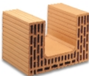
Linteau-chânage T 37,5 x 24 x 25 cm - 14 kg réservation - 18 x 17 cm 60 pièces/palette - 4 pièces/ml
